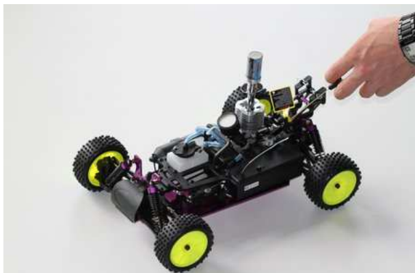
Fahrfertiges Auto mit Anlasser und Seilzug
