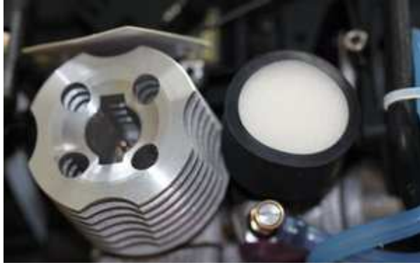
Verbrennermotor mit Hauptdüsennadel
